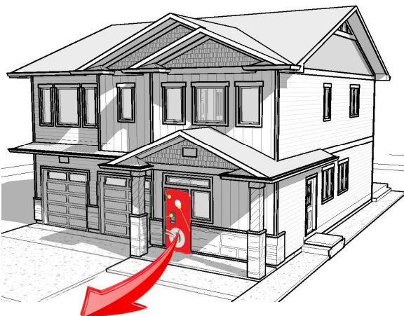
Blower Door Test
